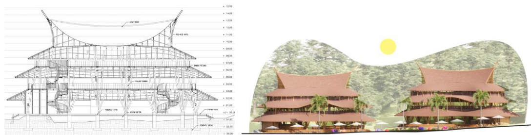
Gambar 11. Potongan dan tampak bangunan gedung utama hotel
