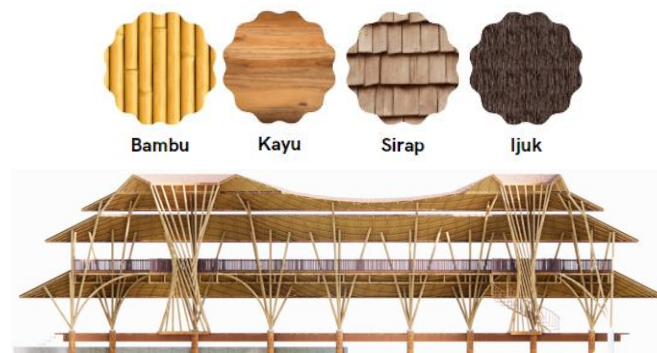
Gambar 6. Penerapan struktur bambu pada gedung resepsionis
