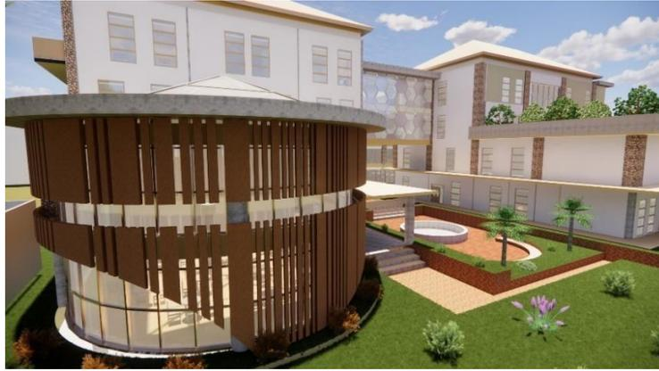
Gambar 5. Desain *secondary skin* pada fasad bangunan dengan pola linear
