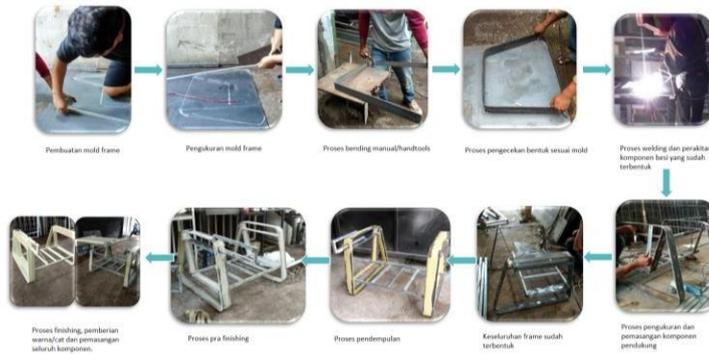
Gambar 43. Proses Produksi Frame (Sumber : Dokumentasi Pribadi)
