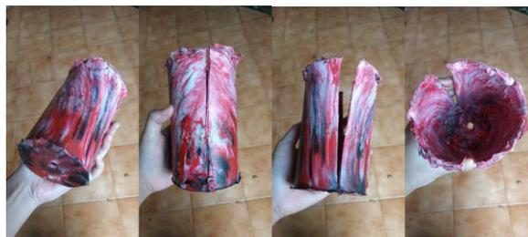
*Gambar 13. Hasil percobaan kedua dengan cetakan besi pipa*
