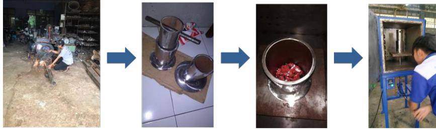
*Gambar 10. Proses perakitan cetakan dan pemanasan*
