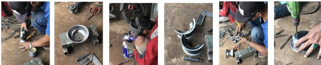
Gambar 8. Proses pembuatan cetakan berbahan mangkuk aluminium
