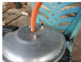
Gambar 35. Pemasangan selang penghubung pada tutup katel bahan Sumber : Dokumentasi Penulis
