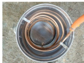
Gambar 36. Pemasangan pipa penghubung pada pipa pendingin Sumber : Dokumentasi Penulis
