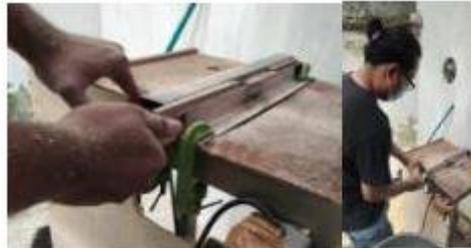
Gambar 3 proses pemotongan modul pipih bonggol jagung menjadi 2 bagian menggunakan table saw
