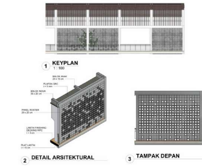
Gambar 1. 8 Gambar Detail Fasade Pada Bangunan Utama
