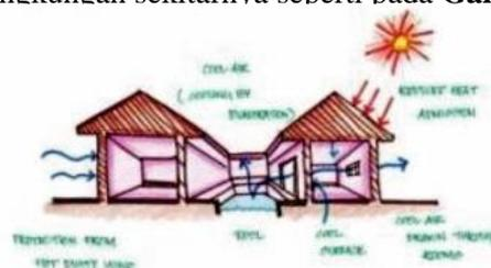
**Gambar 7. Cooling effect dengan kolam pada tengah bangunan**
