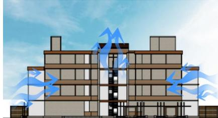
**Gambar 8 Cross Ventilation pada Bangunan Single Loaded**
