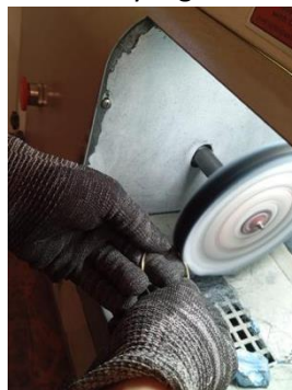
Gambar 23. Proses pemolesan perhiasan.
