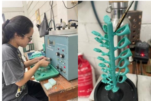
Gambar 11. Proses wax injection dan pembuatan pohon lilin.
