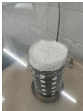
Gambar 13. Proses vacuum cetakan gipsum.
