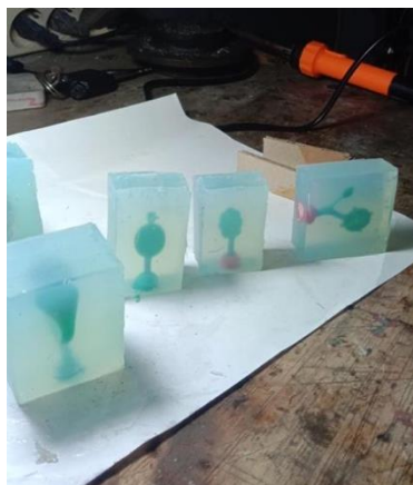
Gambar 10. Pembuatan cetakan dari silikon rubber.
