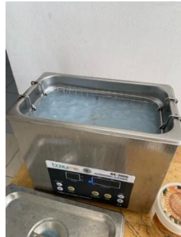
Gambar 24. Proses pencucian dengan alat ultrasonic.
