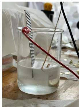
Gambar 25. Proses pelapisan emas.
