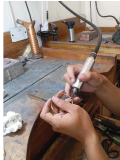
Gambar 21. Pengamplasan dengan alat mini bor.
