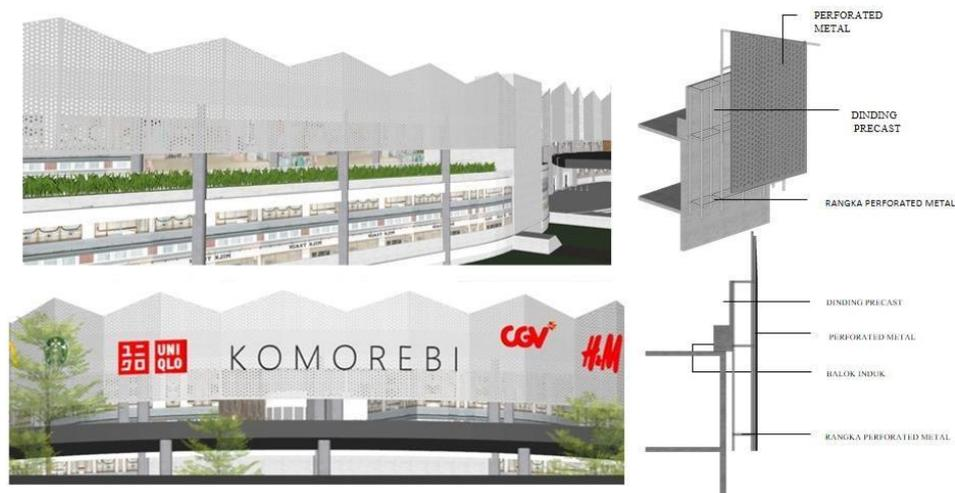
**Gambar 14. Bentuk Fasad Bangunan dengan Bentuk Segitiga dari Perforated Metal**
