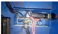
**Gambar 2.6. Catu daya, transformator, dan *fuse* yang sudah terhubung**
