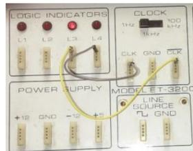
Gambar 3.5. Pengecekan Clock dan  $\overline{\text{Clock}}$
