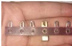
**Gambar 2.5. Terminal strip untuk menghubungkan catu daya, transformator, dan *fuse***
