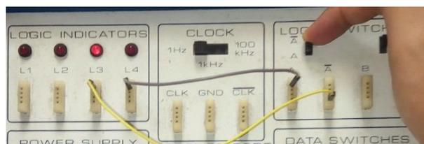
Gambar 3.6. Pengecekan *Logic Switches* A dan  $\overline{A}$
