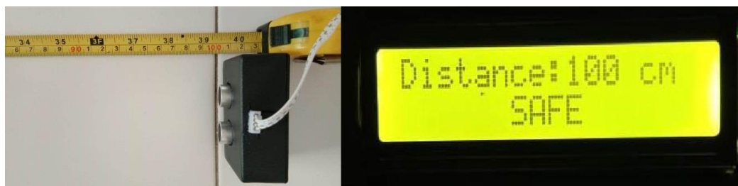
(a) (b) Gambar 8. Hasil Pengujian Menggunakan Media Kardus Berukuran 18x15cm (a) Pada Jarak Sebenarnya (b) Pada LCD Display
