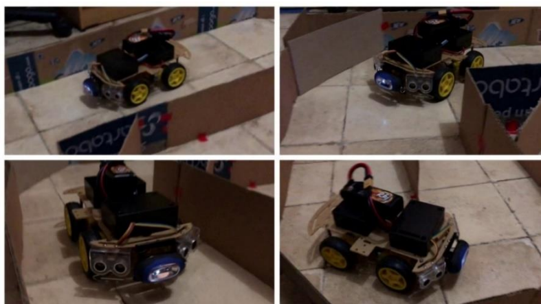
Gambar 11. Robot berjalan lurus, robot belok ke arah kiri, robot kembali berjalan lurus, robot belok ke arah kiri (dilihat dari kiri ke kanan)
