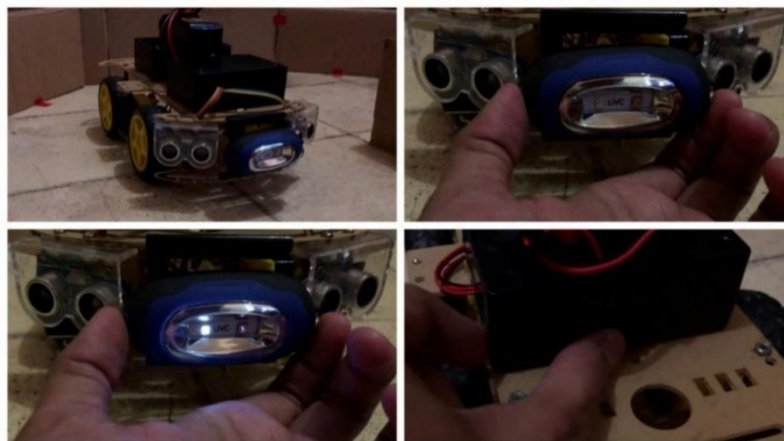
Gambar 10. Posisi awal robot avoider , menghidupkan lampu UVC Portable , lampu UVC Portable menyala, menghidupkan sakelar pada sistem robot avoider (dilihat dari kiri ke kanan)
