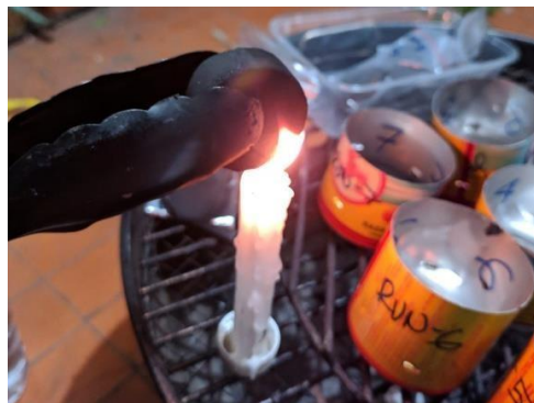
Gambar 2 Proses uji nyala menggunakan api lilin
