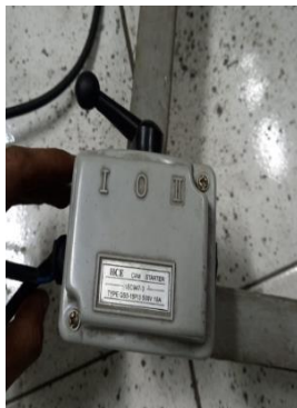
Gambar 13. Hidupkan Motor Listrik Pada Cam-Starter
