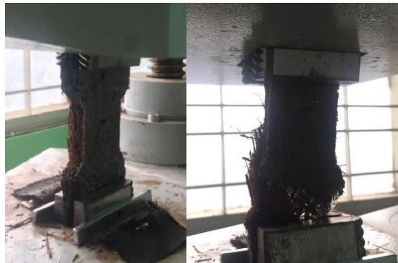
Gambar 5. Fenomena Patahan Uji Tarik
