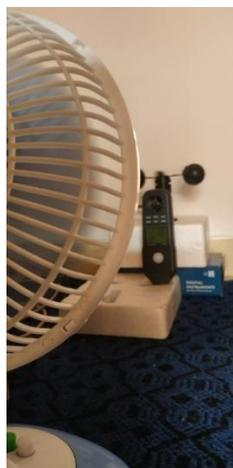
**Gambar 3. Proses Pengkalibrasian Sensor Kecepatan Angin.**
