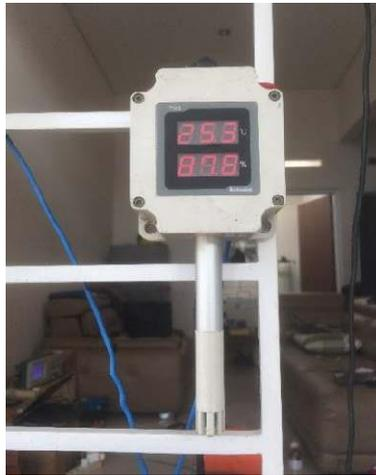
**Gambar 4. Pengukuran Menggunakan Thermometer dan Hygrometer**
