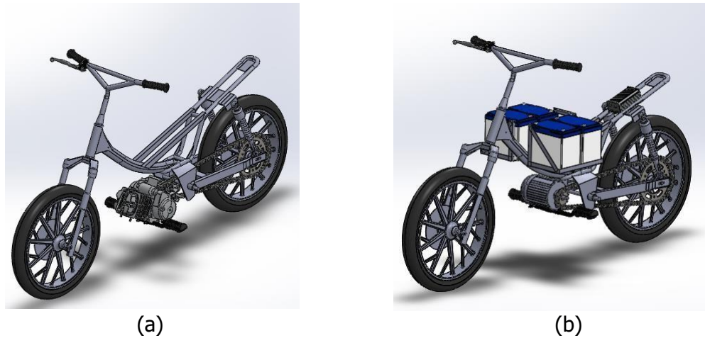
Gambar 2. Ilustrasi konversi sepeda motor bakar menjadi motor listrik (a)menggunakan motor bakar (b) menggunakan motor listrik
