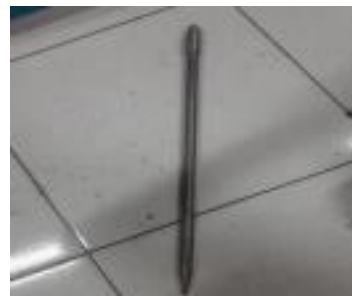
Gambar 8. Pembuatan poros penghubung turbin ke generator
