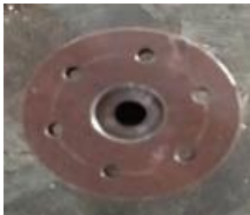
Gambar 7. Kontur pipa hub penghubung turbin ke generator
