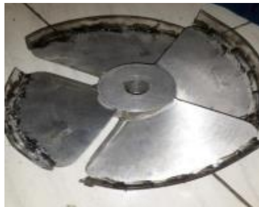
Gambar 11. Blade Turbin dengan Fin
