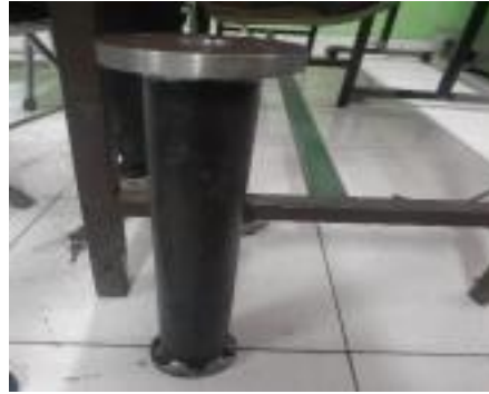
Gambar 6. Pembuatan pipa hub untuk poros penghubung turbin ke generator
