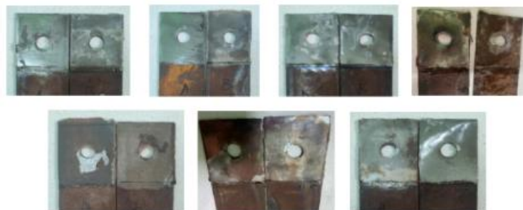
Gambar 10. Patahan spesimen Variasi lubang \phi 15
