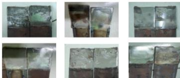
Gambar 9. Patahan spesimen tanpa lubang
