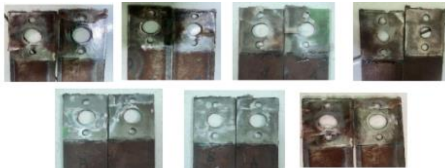
Gambar 12. Patahan spesimen Variasi lubang ø8, ø20, ø8
