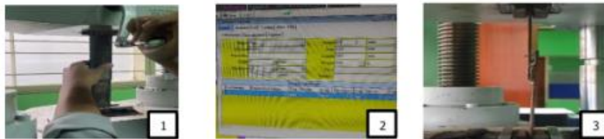
Gambar 11. Langkah-langkah pengujian tarik
