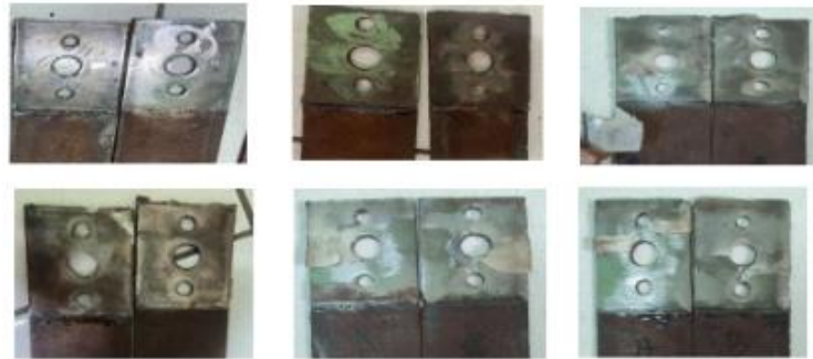
Gambar 11. Patahan spesimen Variasi lubang ø8, ø15, ø8
