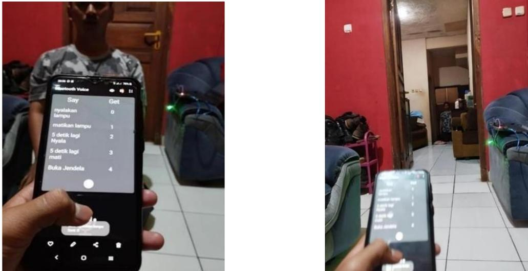
**Gambar 6. Proses Pengujian Efektifitas Jarak dari Sumber Suara ke Aplikasi Android Bluetooth Voice dari Jarak 60 cm Sampai dengan 840 cm.**
