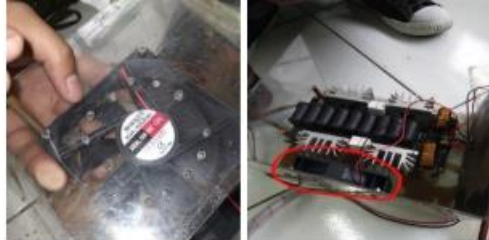
Gambar 13. Pemasangan Kipas 12V
