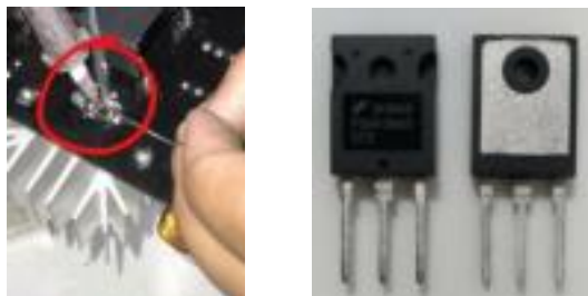
Gambar 8. Pemasangan Transistor Mosfet
