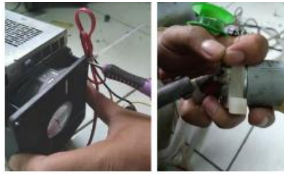
Gambar 20. Pemasangan Kipas 12V & Pompa
