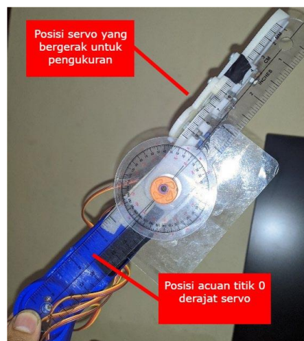
Gambar 4. Peletakan Goniometer pada Joint Elbow
