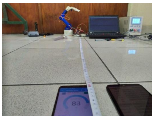
Gambar 5. Posisi Robot Manipulator untuk Pengujian Jarak
