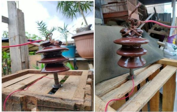
Gambar 3. Pemasangan Isolator Terbuka dan Tertutup
