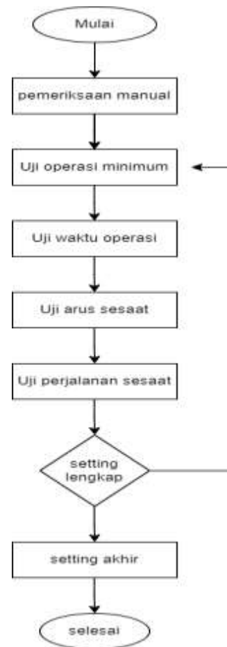
Gambar 2 diagram alir penentuan setting rele arus lebih pada generator
