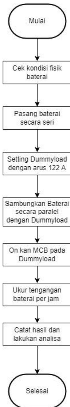
Gambar 1. Diagram alir Pengujian Baterai
