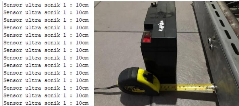
**Gambar 3.2 Hasil pengujian sensor ultrasonik**
