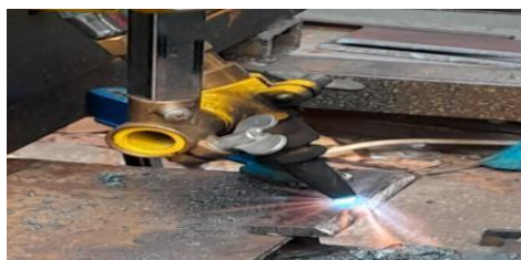
Gambar 1. Pembuatan Kampuh V
