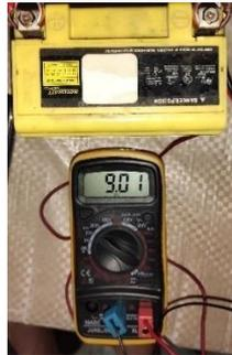
**Gambar 3. 3 Tegangan baterai setelah diuji**
