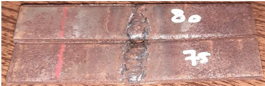
**Gambar 4.7 Spesimen Arus 75 A dan 80 A**
