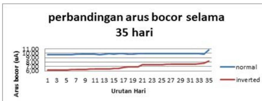
**Gambar 4 Perbandingan harian arus bocor normal dan inverted**
