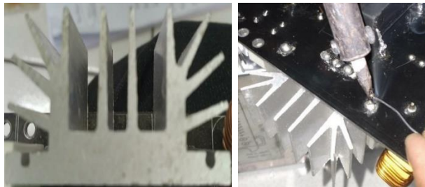
Gambar 7. Pemasangan Heatsink pada PCB
