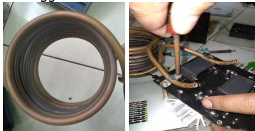
Gambar 12. Pemasangan Koil Kumparan Kerja Ke PCB
