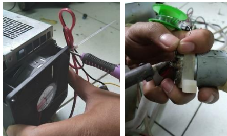
Gambar 20. Pemasangan Kipas 12V & Pompa
