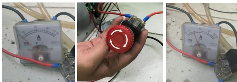
Gambar 24. Ampere Meter Sebelum ada Arus (a) Switch Emergency (b) Ampere Meter Setelah Ada Arus (c)
