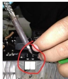
Gambar 10. Pemasangan Resistor Kapur
