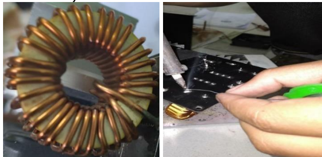
Gambar 5. Pemasangan Induktor Teroid Pada PCB
