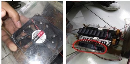
Gambar 13. Pemasangan Kipas 12V
