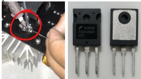
Gambar 8. Pemasangan Transistor Mosfet
