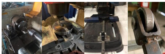
Gambar 2.15 Proses pembuatan armshaft
