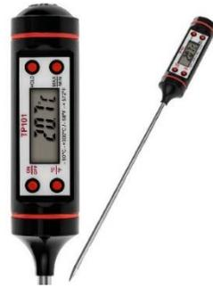
**Gambar 3. Termometer Makanan sebagai Termometer Referensi**
