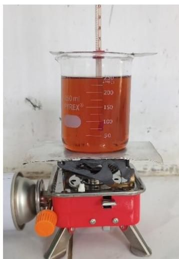
**Gambar 9. Proses Pemanasan Oli Menggunakan Kompor *Portable***
