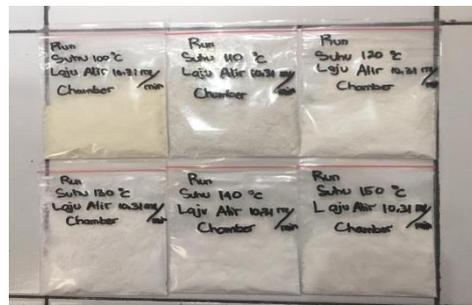
**Gambar 8. Produk Chamber Pada Temperatur 100°C - 150°C Dengan Laju Alir Umpan 10,31 mL/menit**
