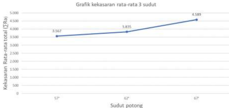
Gambar 15. Grafik nilai kekasaran benda kerja untuk sudut potong 67° sudut buang 15° sudut bebas 8°
