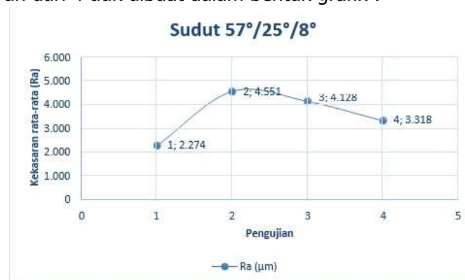
Gambar 6. Grafik nilai kekasaran benda kerja untuk sudut potong 57° sudut buang 25° sudut bebas 8°
