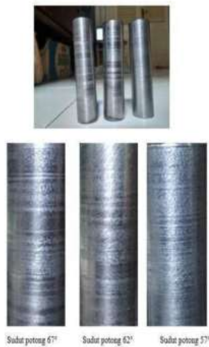
Gambar 4. Hasil pembubutan ST-37 oleh variasi sudut pahat
