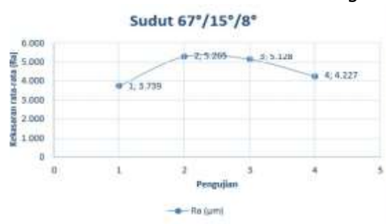
Gambar 14. Grafik nilai kekasaran benda kerja untuk sudut potong 67° sudut buang 15° sudut bebas 8°
