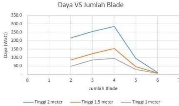
**Gambar 9 Daya Vs Jumlah blade pada kecepatan angin 6 m/s**
