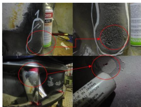
Gambar 5. Hasil Dye Penetrant Pada Runner Blade
