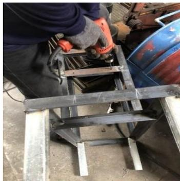
**Gambar 5. Pembuatan Frame**
