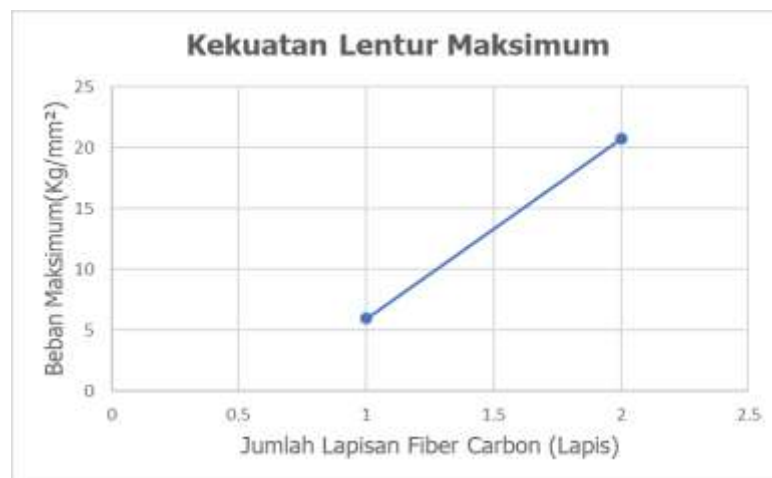
Gambar 7. Kekuatan lentur maksimum honeycomb beam variasi 1 dan 2 lapisan serat karbon
