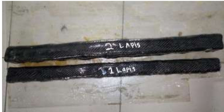
Gambar 4. Honeycomb beam berbahan komposit serat karbon yang sudah jadi
