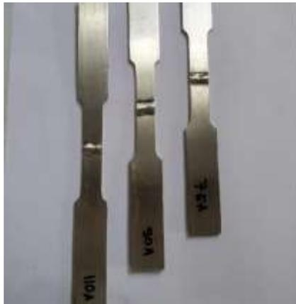
**Gambar 3. Spesimen Uji Tarik**
