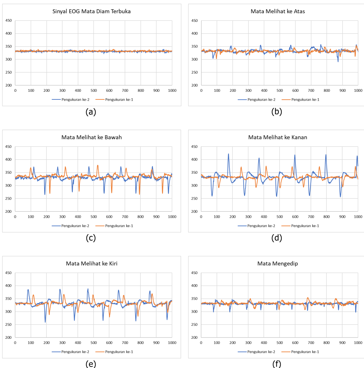
Gambar 8. Grafik Sinyal EOG saat Referensi Terpasang di Belakang Daun Telinga (Pengukuran ke-1) dan saat Referensi Terpasang di Leher (pengukuran ke-2), di mana (a) Gerakan Mata Diam Terbuka, (b) Gerakan Mata Melihat ke Atas, (c) Gerakan Mata Melihat ke Bawah, (d) Gerakan Mata Melihat ke Kanan, (e) Gerakan Mata Melihat ke Kiri, (f) Gerakan Mata Mengedip
