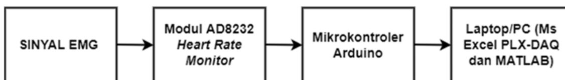
**Gambar 1. Blok Diagram Sistem Pengukur Sinyal EMG**
