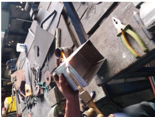
Gambar 7. (A) Proses pembuatan casing control valve (B) Proses pembuatan mounting control valve
