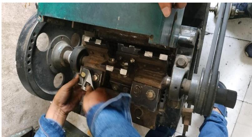
**Gambar 3. Pemasangan pisau pada mesin pencacah akrilik**
