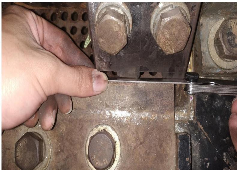
**Gambar 2. Proses pemasangan dengan *feeler gauge* 1mm**
