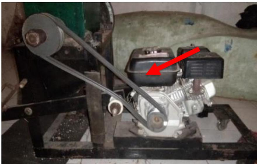
**Gambar 6. Posisi peletakan *tachometer* untuk mengukur putaran motor**
