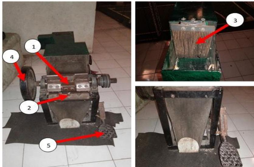
**Gambar 4. Komponen mesin pencacah akrilik**
