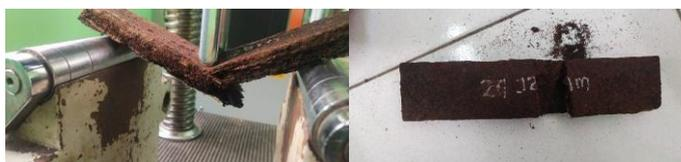
**Gambar 7.** Fenomena Patahan Uji Bending
