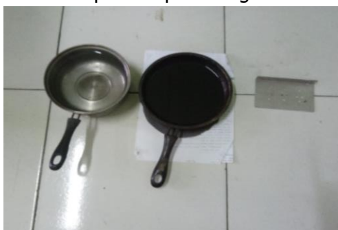
Gambar 6. Media pendinginan (air, oli dan udara)
